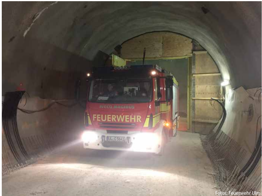
Einfahrt eines Löschgruppenfahrzeuges in eine Tunnelröhre durch eine Wetterwand
