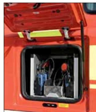
**Raumnutzung:** Im seitlichen Kabinenstufach auf der Beifahrerseite sind die tragbaren Sprechfunkgeräte montiert.
