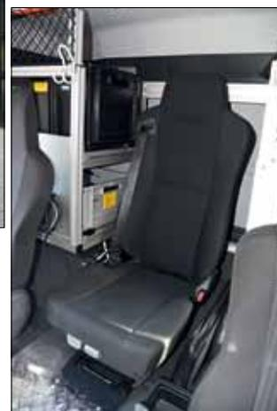
**Für drei:** Zwischen Fahrer- und Beifahrersitz ist etwas zurückgesetzt ein dritter, vollwertiger Sitz für die Besatzung (1+2) eingebaut.
